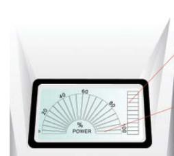
La charge de la batterie est aisément contrôlable sur le témoin de charge. Une batterie pleine équivaut à 10 unités sur le témoin. La charge de batterie ne s'indique que moteur à l'arrêt.
